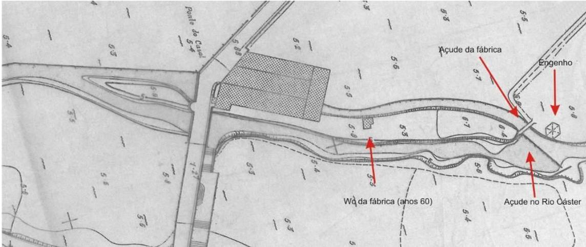
Fig. 65 - Fábrica, açude, levada e nora - levantamento topográfico, finais da déc. 80, séc. XX. Atendendo a que a cobertura da nora tinha já sido removida, foi efectuada somente o levantamento da estrutura. Implantação António França.
