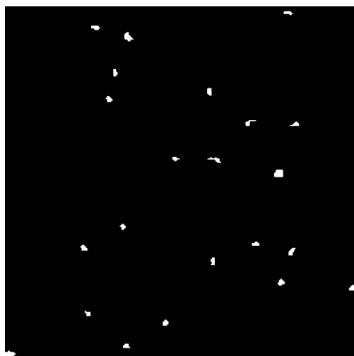
Figura 4.11 - Imagem da eliminação dos objectos com área maior que 500 ou menor que 50 (ponto 17).
