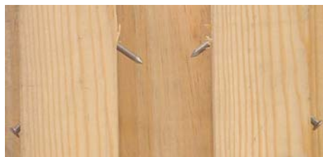
Figura 3.11 Modo de rotura característico dos provetes da Série 2 (Prego redondo a 135°)
