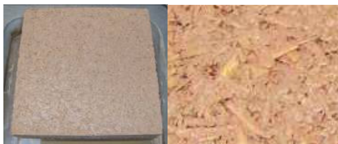
Figura 10 – Placas de compósito de cânhamo produzidas sob compactação mecânica. a) placa após a compactação e b) textura da placa (escala 1:1).
