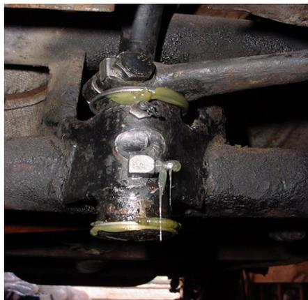
**Figura 15** - Lubrificação de um Sinobloco
