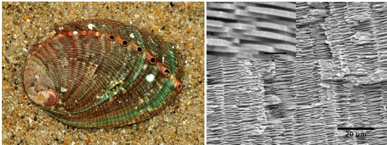
Figura 1: Concha de Abalone: fotografia e microestrutura [5]
