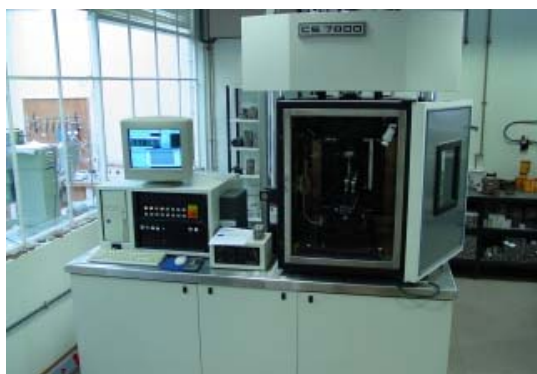
Fig. 3 – Equipamento servo-hidráulico para realização dos ensaios de fadiga.
