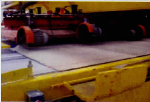
Figura 1 - Produção de materiais compósitos de fibrocimento pelo processo Hatscheck [5]
