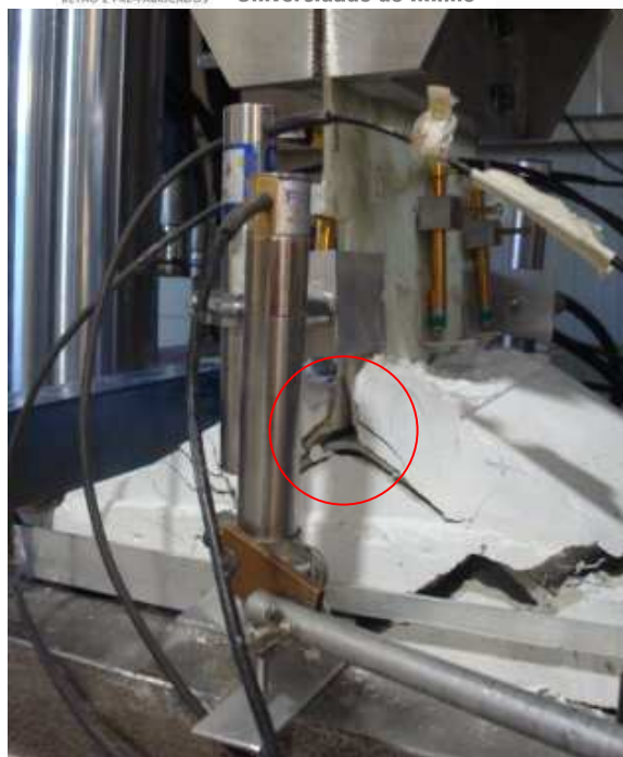
Figura 43 – Delaminação verificada no perfil de FRP durante os ensaios com as conexões tipo Y.
