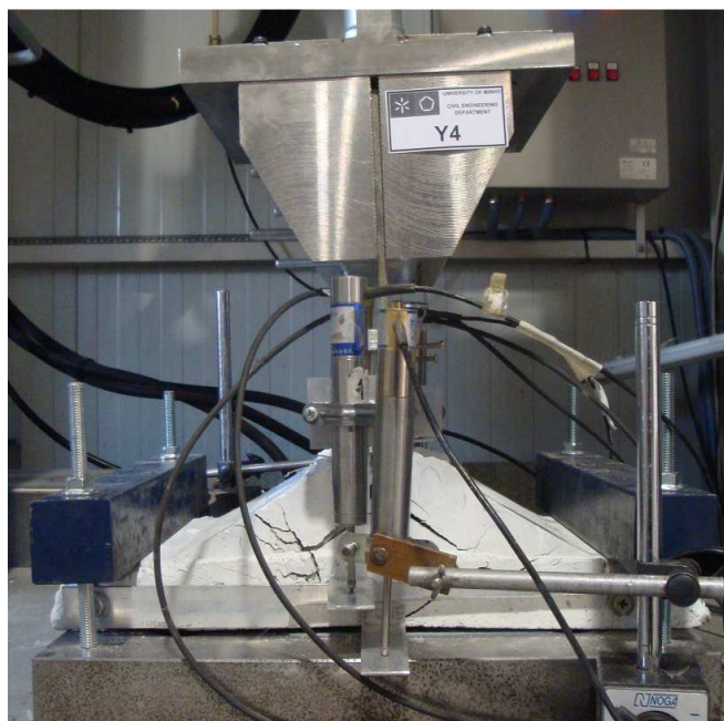
Figura 41 – Fendilhamento múltiplo verificado nos provetes constituídos por conectores tipo Y embecidos.
