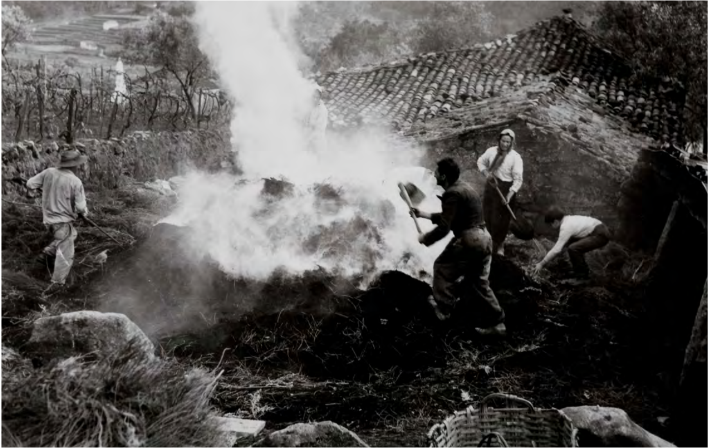
60 Em plena cozedura. Inicia-se o abafar da loiça de modo a criar uma atmosfera redutora, Séc. XX, 3.º quartel The firing process. The pottery smothering stage begins so as to create a reduction atmosphere, 20 th century, 3 rd quarter
