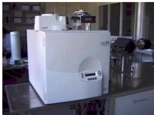
Figura II.12 – Equipamentos envolvidos na análise dos isótopos de enxofre no ICAT: (a) – espectrómetro ISOPRIME (Micromass, UK) e (b) - analisador elemental EUROEA (EuroVector, Itália).
