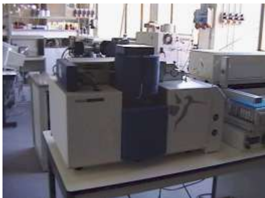
Figura II.12 – Equipamentos envolvidos na análise dos isótopos de enxofre no ICAT: (a) – espectrómetro ISOPRIME (Micromass, UK) e (b) - analisador elemental EUROEA (EuroVector, Itália).
