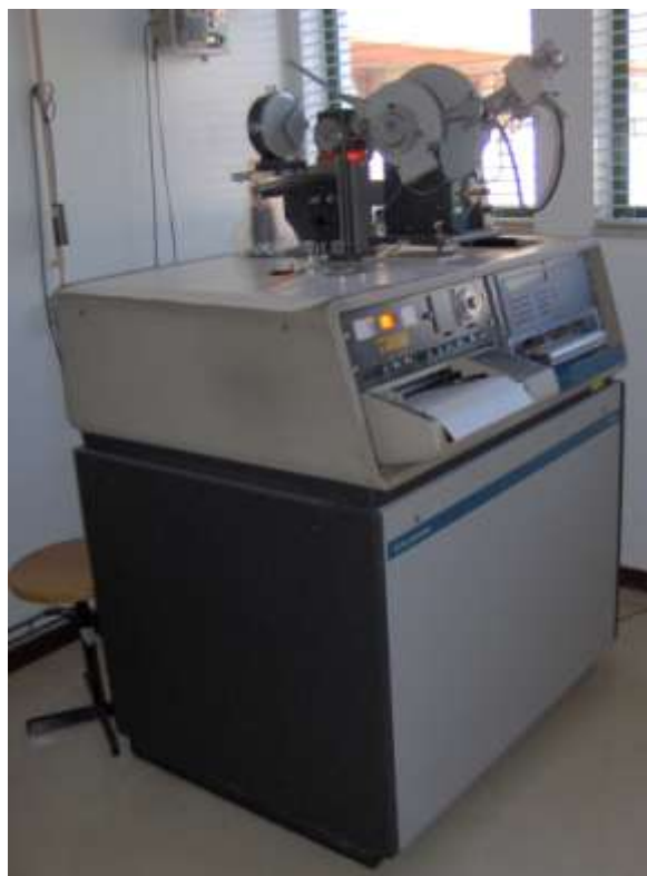
Figura II.11 – Difractómetro de Raios – X - Philips PW 1710. (Departamento de Ciências da Terra – Universidade do Minho)
