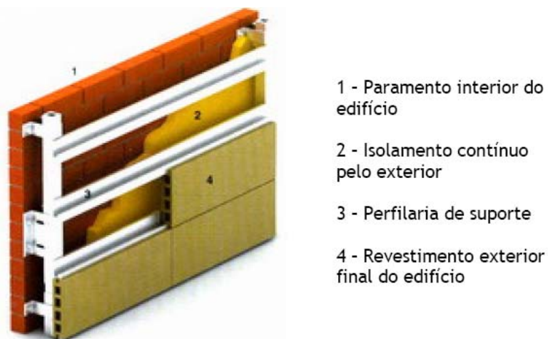
Figura 4.10 – Pormenor sistema fachada ventilada [39]
