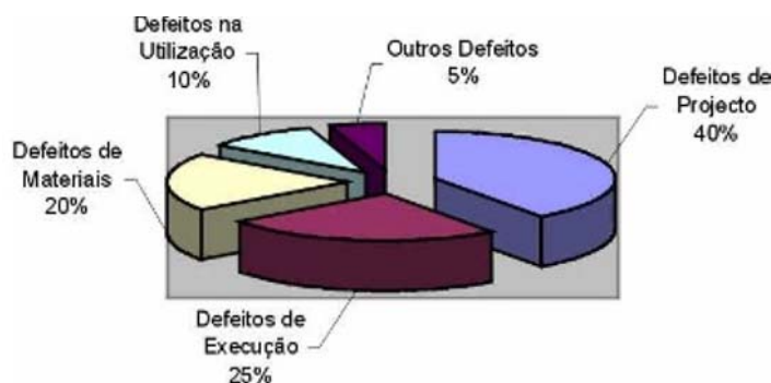
Figura 2.4 – causas de anomalias em edifícios [14]
