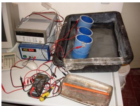
Figura 3-15 - Instalação do ensaio do coeficiente de difusão dos cloretos
