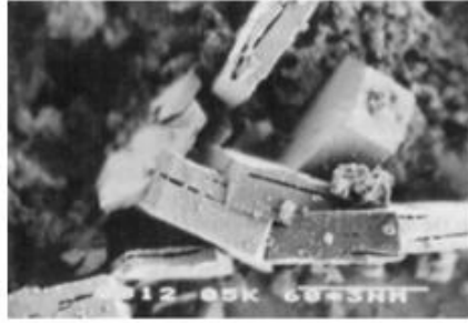
Figura 4-20 - Cristais de hidróxido de cálcio na zona de transição
