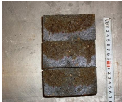
Figura 3-16 - Medição da penetração dos cloretos
