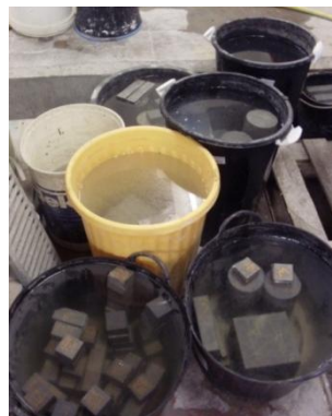
Figura 3-9 - Armazenamento dos provetes
