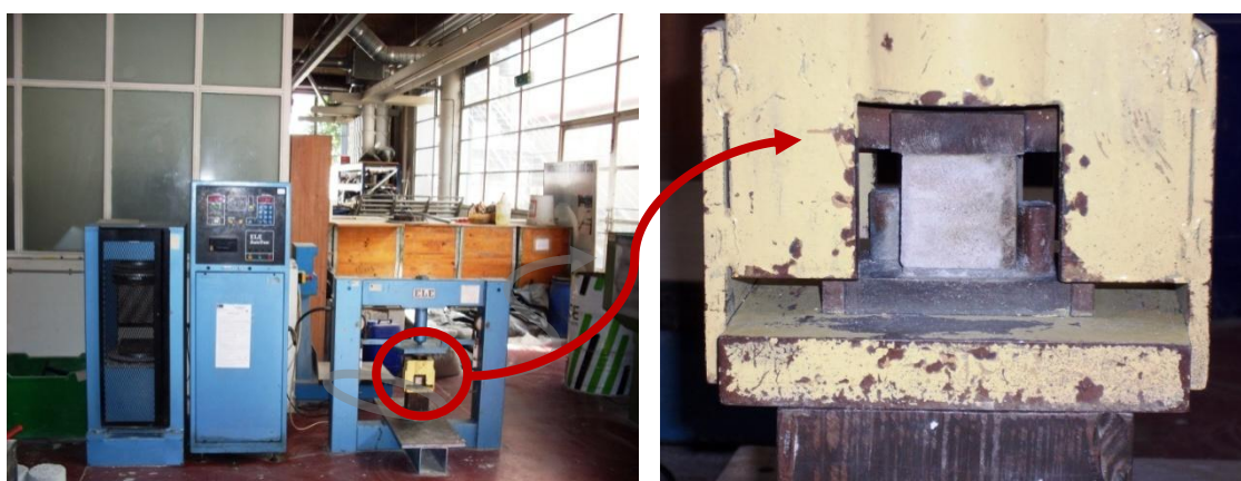
Figura 3-11 - Máquina universal de ensaios ELE - ensaio à compressão
