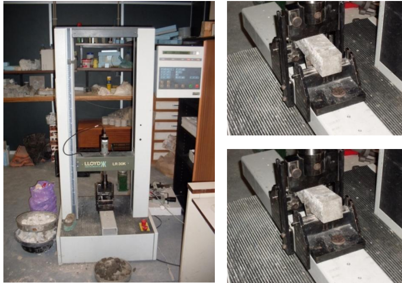
Figura 3-10 – Máquina universal de ensaios Lloyd - ensaio à flexão
